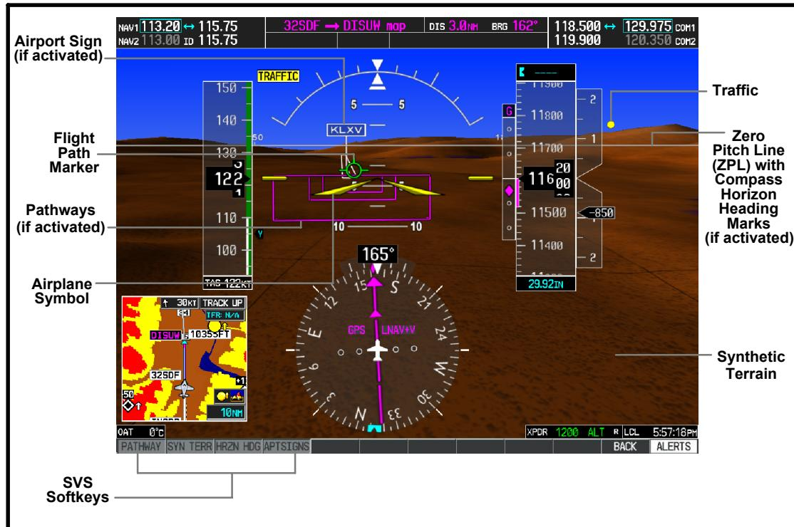
**FIGURE 1-2 SYNTHETIC VISION ON PRIMARY FLIGHT DISPLAY**
